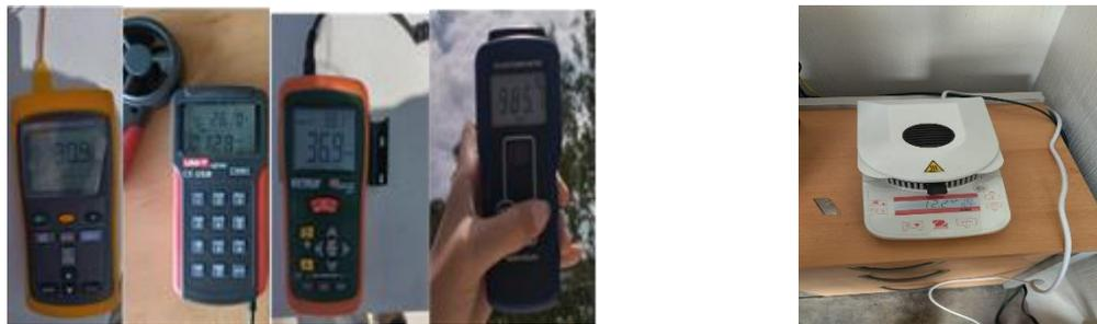
Figura 4 Termómetro digital con termopar, anemómetro, higrómetro medidor de humedad y medidor digital de energía solar y balanza de humedad
